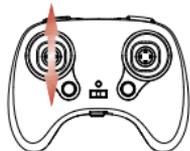
④ Jale la palanca izquierda para arriba y después para abajo para emparejar el transmisor. Las luces de los indicadores se encenderán y se quedaran prendidos indicando que la conexión a sido establecida.
