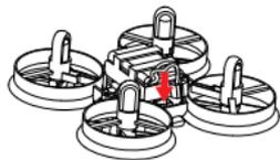
① Conecte la batería al dron para encenderlo.
