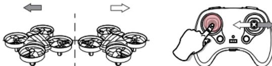
Si el dron se esta desplazando para la izquierda, presione la palanca izquierda y no la suelte, mientras tanto, mueva la palanca derecha hacia la derecha para balancear el dron. Si el dron se esta desplazando hacia la derecha, presione la palanca izquierda y no la suelte, mientras tanto, mueva la palanca derecha hacia la izquierda para balancear el dron.
