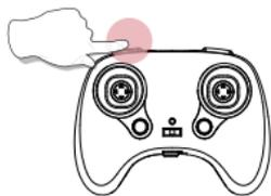
Este dron viene con 3 niveles de velocidad (baja, mediana, alta). Presione el botón de cambio de velocidad localizado en la parte superior izquierda del transmisor. Suba o baje la velocidad una velocidad a la vez. Un pitido del transmisor indica que usted esta volando en velocidad baja, dos pitidos indican velocidad media, y tres pitidos indican alta velocidad.
