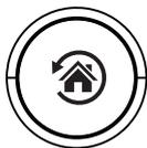
RC Inteligente: Presione este botón y el dron volverá a la posición vertical del punto de despegue que establezca, luego aterrizará solo. **(Esta función solo puede funcionar en modo GPS.)**
